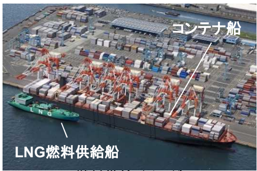
燃料供給イメージ (荷役と並行して燃料供給が可能)
